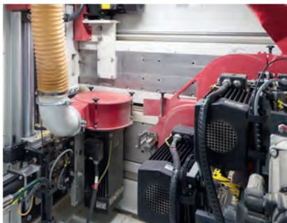
左側は逆回転の最初のジョイントカッター、その後上下のホッガーに進みます。
