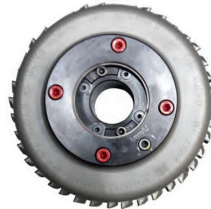
ツールの中央にハイドロクラッピングスリーブがあります。1つのネジは工具の外側にもう一方のネジはスピンドルの内側に作用します。
