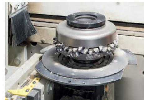
ジョイントカッターが露出し、六角レンチで上から簡単に調整できます。
