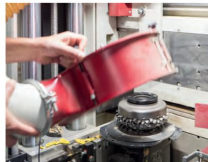
刃先の位置を調整するにはダストカバーを外します。
