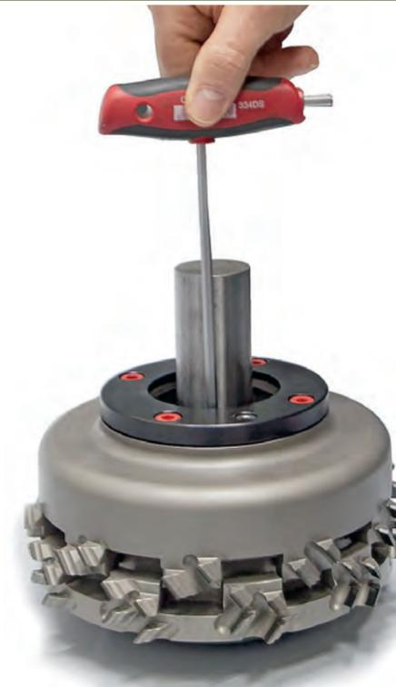
ジョイントカッターは2本のネジでロックと解除ができます。3本目のネジは幅調整ができます。ゼロラインはツール中心部の高さに重なります。
