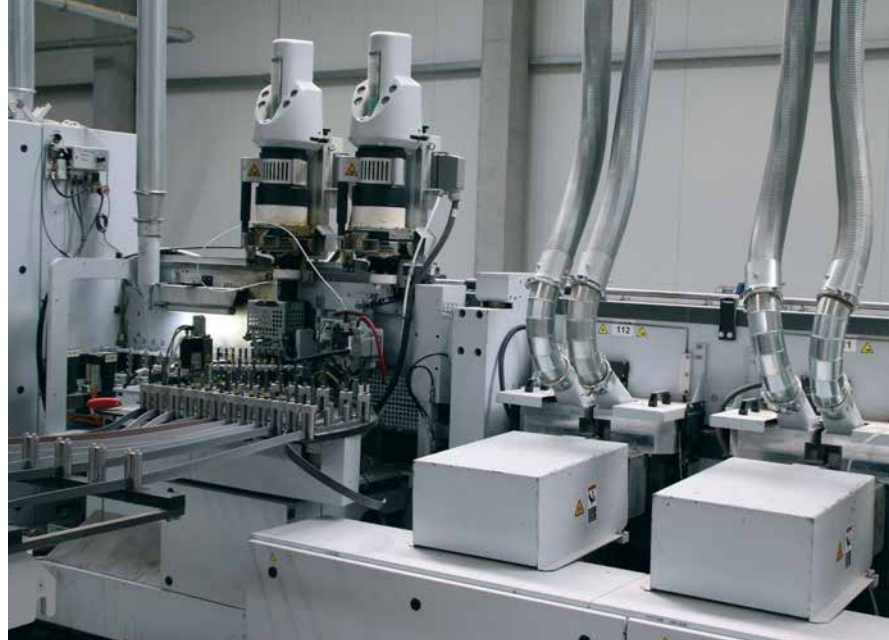
Deutlich erkennbar: Die vier Fügestationen auf der Maschine, bevor die Kante anschließend mit dem Werkstück verklebt wird.
