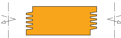
Profiel 2 met verspringende randvingerlassen
