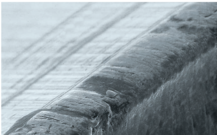
Usure de l'arête tranchante.
