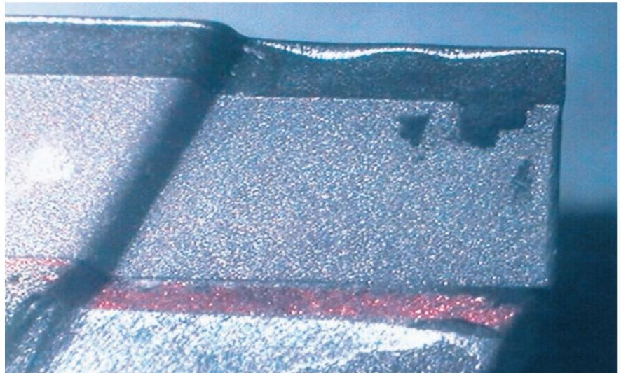
Schneidkantenverrundung nach Einsatz in GFK.
