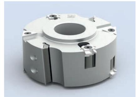
Wendeplatten Falzmesserkopf mit Zusatzschneiden (Kantenmesser): Universelles Werkzeug zum Fügen, Falzen und Abrunden/Fasen.
