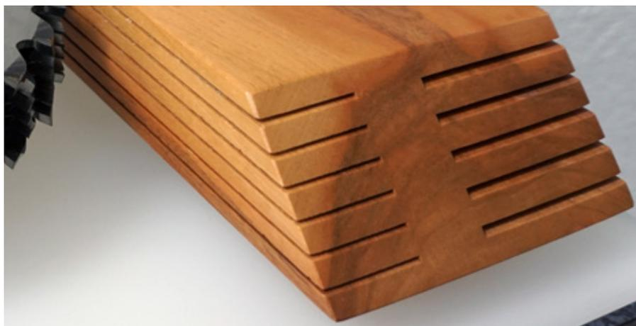
Por exemplo, usando lâminas de serra circular de corte fino Leitz, podem ser produzidas 7 em vez de 6 lamelas. Isso significa um aumento de produtividade de aproximadamente 17%.
