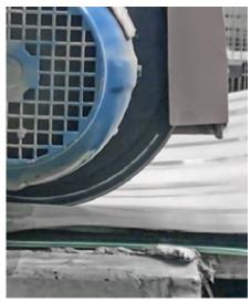
Na produção de painéis de fibrocimento, os discos circulares de metal duro maciço para cortar as lastras úmidas se desgastam particularmente rápido. As consequências são paradas da linha de produção e trocas de ferramentas demoradas.
