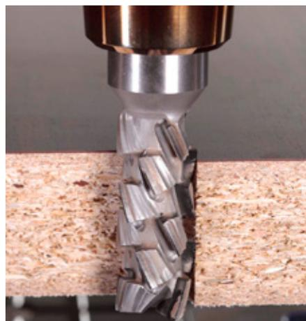
*Diamaster PRO<sup>3</sup> (esquerda) – a primeira escolha para usinagem em máquinas nesting e lotes de tamanho 1.*
