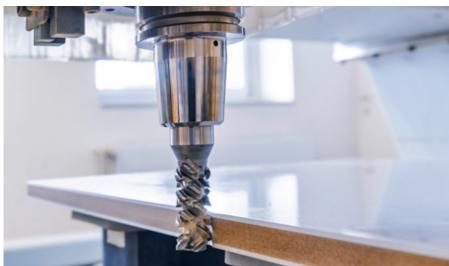
クランピングシステムはツールと機械のインターフェースとして、加工プロセスに決定的な役割を果たします。 従来のチャックでは同心性や安定性、クランプ力が低下し、結果として機械とツールが本来の実力を発揮できません。
