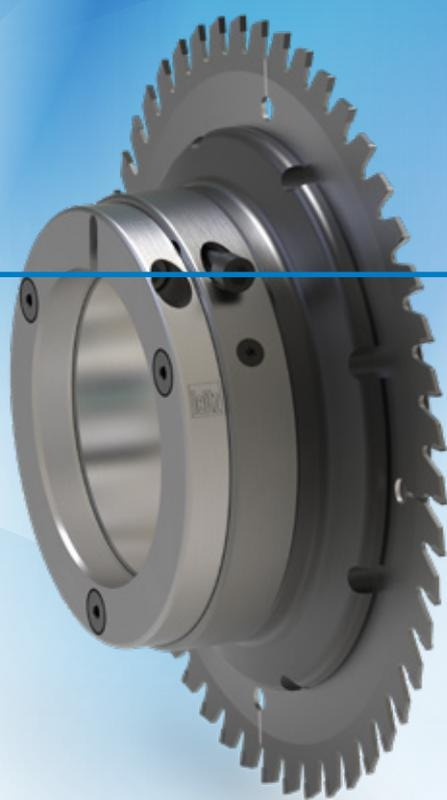
Spesso, il posizionamento di diversi utensili su un unico albero avviene mediante l'impiego di anelli ed il fissaggio tramite un dado dell'albero. L'albero però può deformarsi a causa di errori di parallelismo o di contaminazione da sporco. Inoltre, la conversione ad altre dimensioni del pezzo può richiedere molto tempo.
