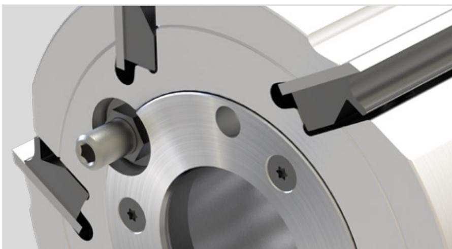
Axialer Betätigungskolben für Druckaufbau
